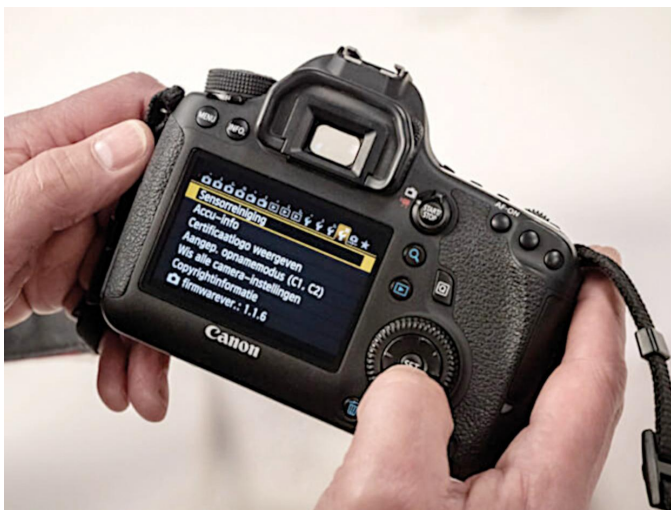
Camerasetting voor het opklappen van de spiegel, om bij de sensor te komen
